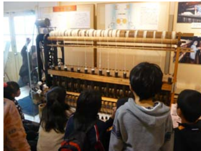
展示見学。写真はかつて三河地方で日本一の生産を誇っていた「ガラ紡機」
